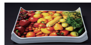
Wasserbasierte Tinten neigen zu Verformungen wie Wellenbildung und Wölbung.
